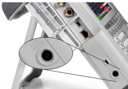
R&S ZVH は、DC コネクタを経由して AC/DC 電源ユニットから電力を供給を受けることができます。DC コネクタを使用してバッテリーを充電することもできます。
